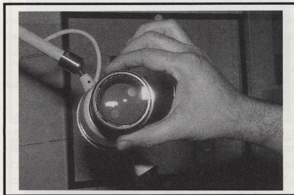
Figura 5. Objetivo manipulado, con filtro rojo y cian, para anaglíficos.
